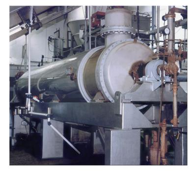
Continuous Hydrolyzor™ O Dupps Continuous Hydrolyzor é a escolha ideal para produtos consistentes de alta qualidade com capacidade de até 13.600 quilos por hora. Todas as partes internas que entram em contato com produtos são de aço inoxidável.
